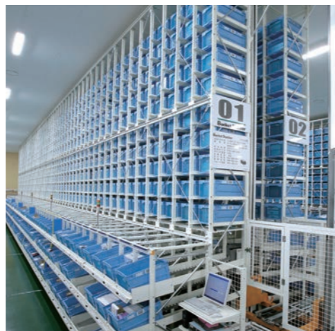
スタッカークレーン式自動倉庫
