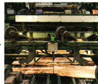
機械で切削し、1枚の板(生単板)にします。
