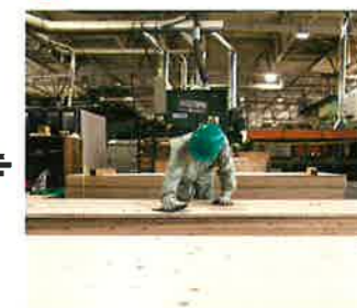
規定サイズに裁断し、表面仕上げを行い、検品します。
