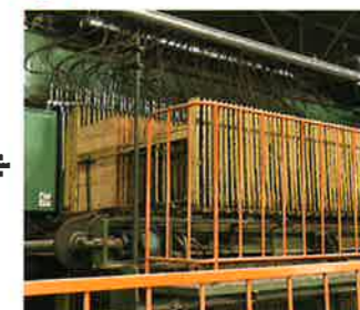
高温で加圧し、完全密着させます。
