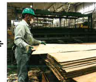
端切れの単板をつないで芯板にし、複数の単板と合わせて仕組みます。
