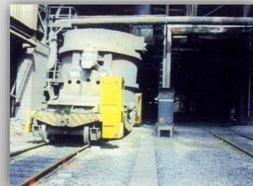
●溶銑台車 (200 t 鍋) 高炉より溶銑を約150 t 受銑して製鋼工場へ輸送
