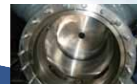
■ レシプロコンプレッサーピストン抜き出し後の清掃作業
