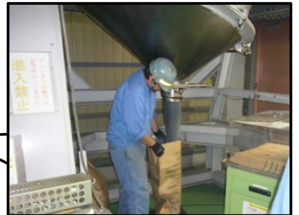
色々なセンサーを通り、規格にマッチしたペ レットだけがKSKの製品です 25kgを計量、包装した後、パレットに積み付 け。後は出荷するだけです！
