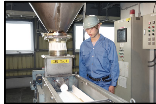
生産開始前に「定量供給装置」の調整をします
