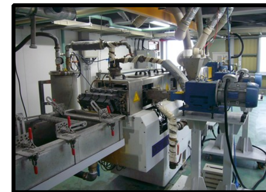
メインの機械「押出機」です ペレットを200℃~400℃でドロドロに溶か します
