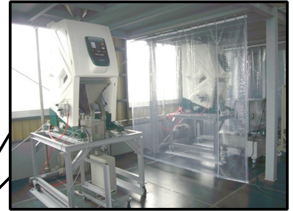
「金属検出機」はその名の通り、金属を 除去する装置です
