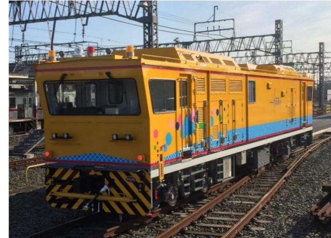
■ 軌道検測車 軌道の高低・通り・水準・軌間平面性の測定、レール探傷・断面の測定を行う
