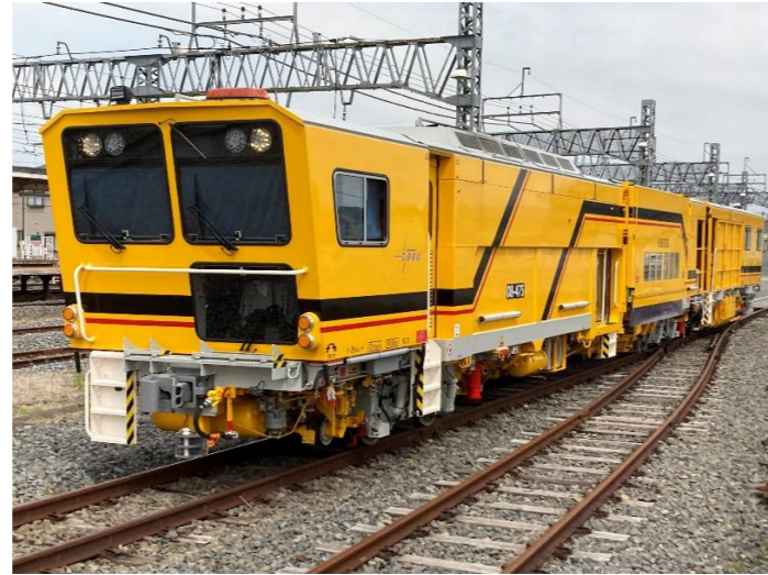
■ スイッチマルチ 分岐器・ガード区間、道床搦固めによる通り・高低水準などの整正を行う
