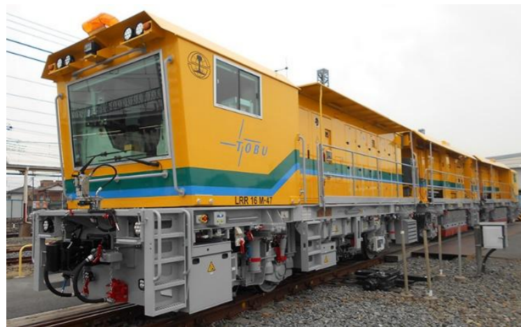
■ レール削正車 レール頭部踏面箇所を削正除去により断面形状の整正を行う
