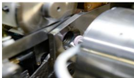
外輪軌道溝研削加工風景
