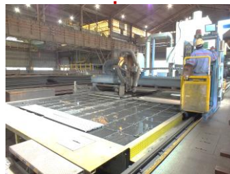
板を指定のサイズに切断
