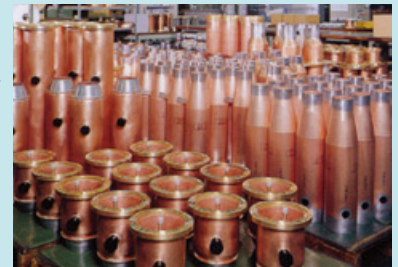
▶ 超高压ケーブル 中間接続用銅管 Copper tube for Ultra high voltage cable jointing
