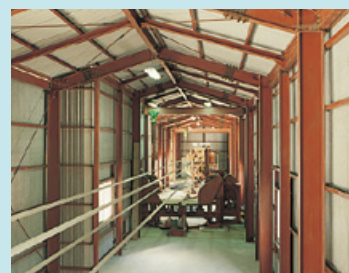
▲ スペーサ振動試験装置 Vibration testing device for transmission line spacer
