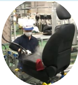
⑩ 外観仕上げ工程
