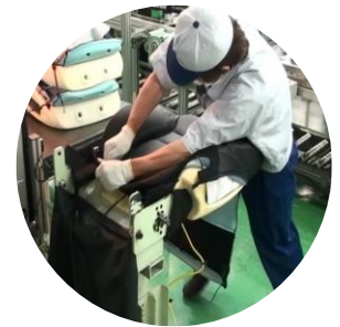
⑦ シートバックの被せ工程
