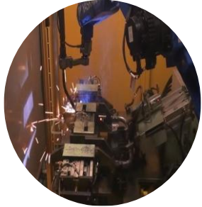
① フレーム溶接工程
