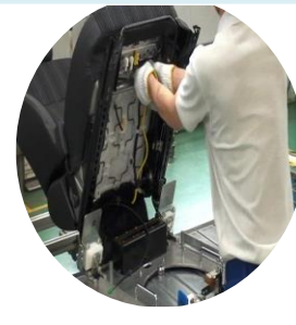
⑧ 配線作業の工程
