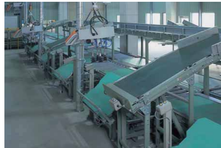
テレビ解体設備
