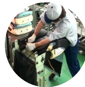
⑦ シートバックの被せ工程
