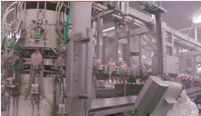
↑自動解体機(むね肉の自動解体をしています)
