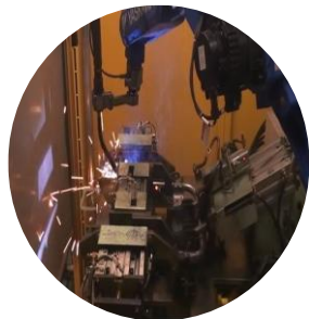
① フレーム溶接工程
