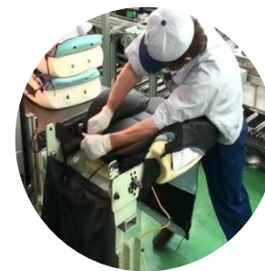
⑦ シートバックの被せ工程
