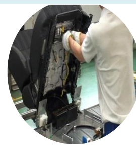
⑧ 配線作業の工程
