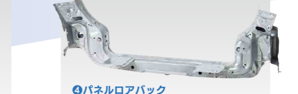
④パネルロアバック テールゲートの開口部を構成する部品です。
