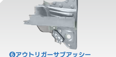
⑥アウトリガーサブアッシー 車両を支える骨格部品です。
