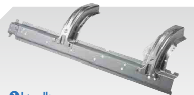
①レール マイクロバスの上側面フレームにあり、ルーフのボデー強化保持の部品です。
