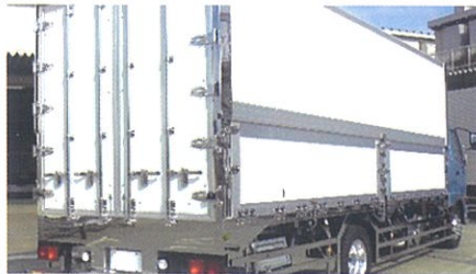
カーボンパネル・冷凍フラップ
