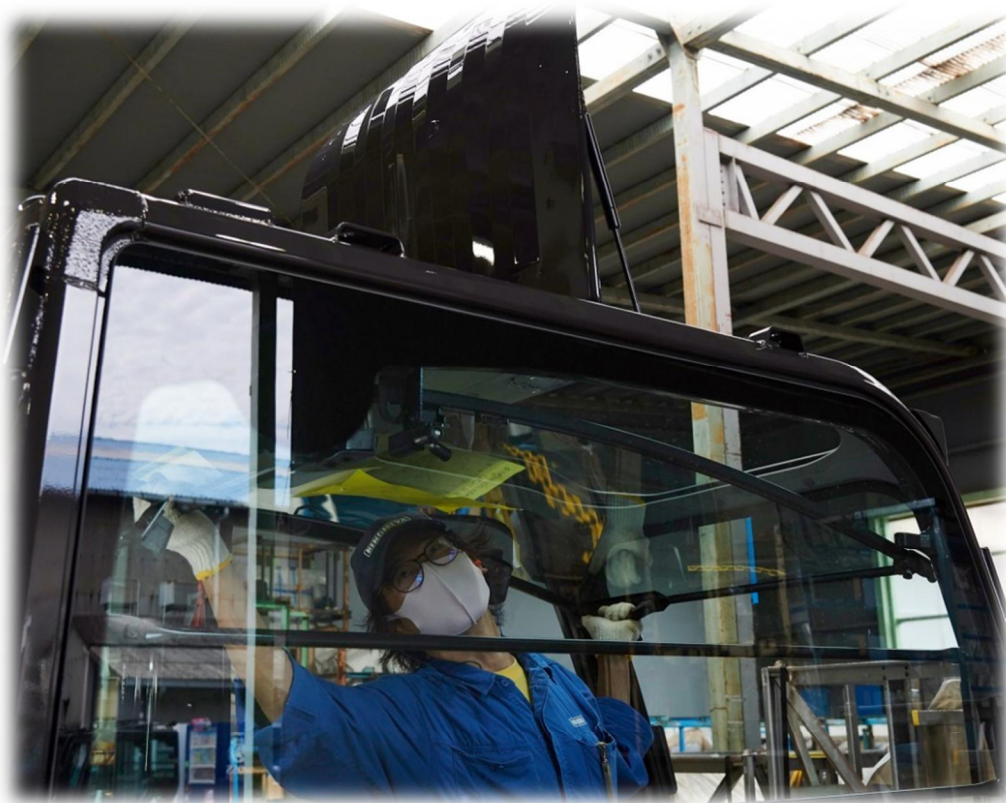
電装品検査/最終検査
