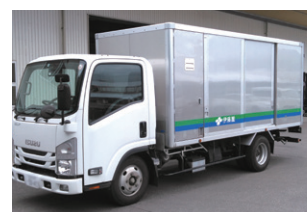
トラック架装 【複合化 (TECCELL+アルミ+茶殻)】 【環境配慮】
