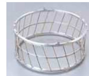
はやぶさ、はやぶさ2再突入分離スプリング Separation spring of HAYABUSA, HAYABUSA II reentry capsule
