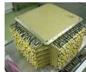
CALET/TASC センサヘッド CALET/TASC sensor head
