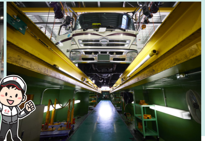
【車両下部の整備はフロアリフトを使ってをおこないます】
