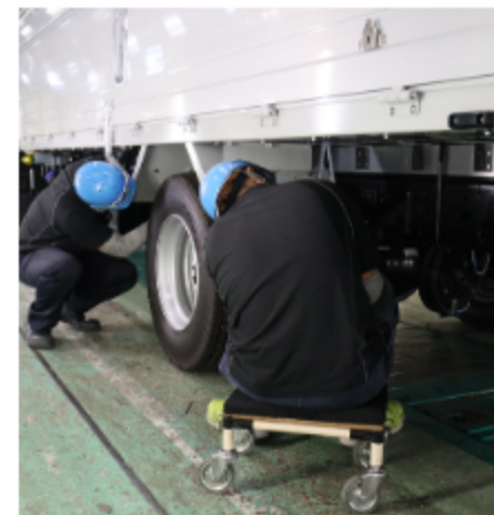
電飾品やバンパー等の艤装品と呼ばれる部品を取りつける艤装工程へ部品を運んでいます。 製造ラインの最後の仕上げです。
