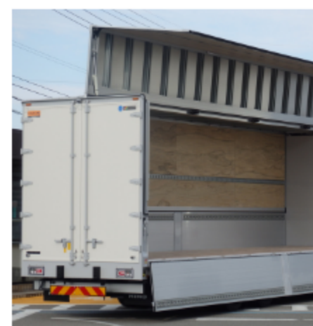
横からフォークリフトなどで積載できるウイングボデー。小型～大型、冷凍車など色々な種類の製品をを設計します。
