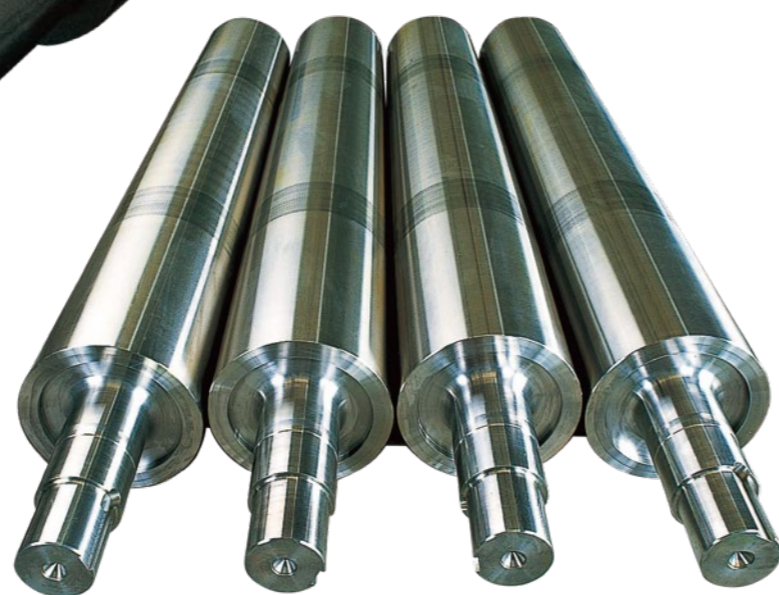
熱延搬送ローラー及び巻取機ラップロール
