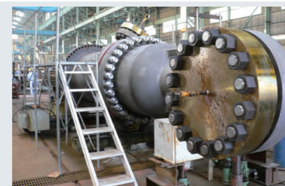
高温高圧熱交換器
