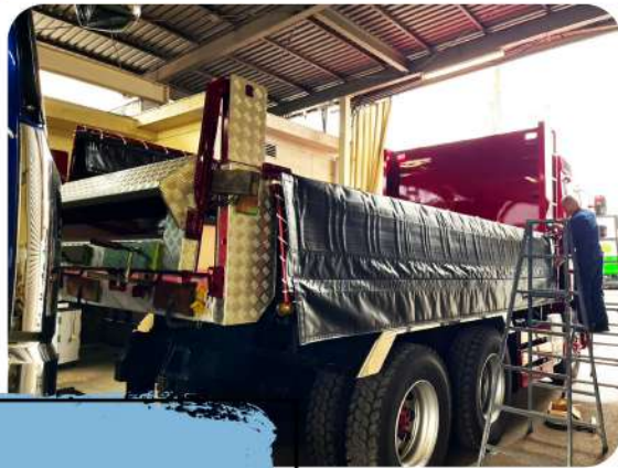
大型ダンプに ダンプシートを取付
