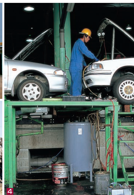
1 自動車前処理場 2 車両運搬 3 自動車プレス 4 オイル抜き取り作業
