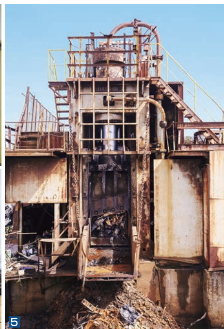
1 シュレッダープラント 2 オペレーター室 3 シュレッダー製品 4 事前選別 5 ギロチンシャー
