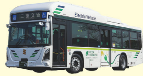
電気 (EV) バス 排出ガスゼロ、最後部席まで床段差のないフルノンステップEV路線バス
