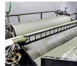
原料を洗い濃縮させて 原料濃度を安定させます。
