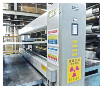
水分、厚み、坪量を計測しゴミや異物がないか検査します。
