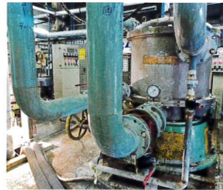
原料を除塵します (機械に通してゴミを取ります)。
