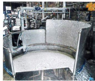
原料(古紙)を溶解します (水を加えてドロドロにします)。
