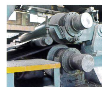
毛布に載った原料をロールとロールの間に通し水を絞り出します。
