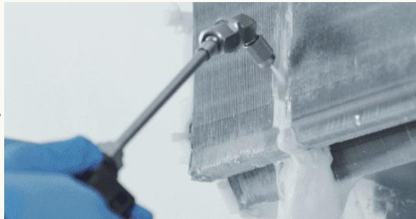
内部洗浄・高圧水・手洗い
