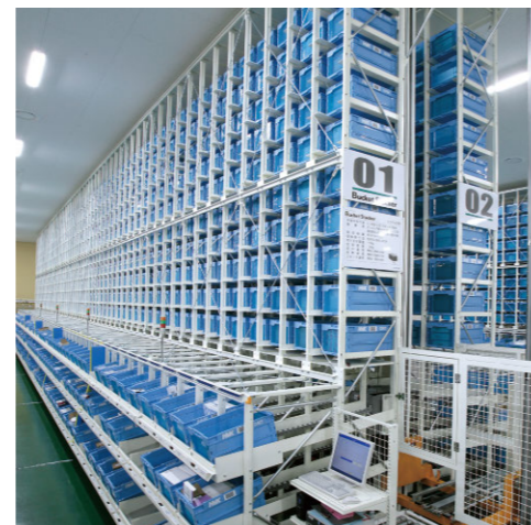
スタックークレーン式自動倉庫
