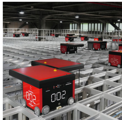
ロボットストレージシステム
