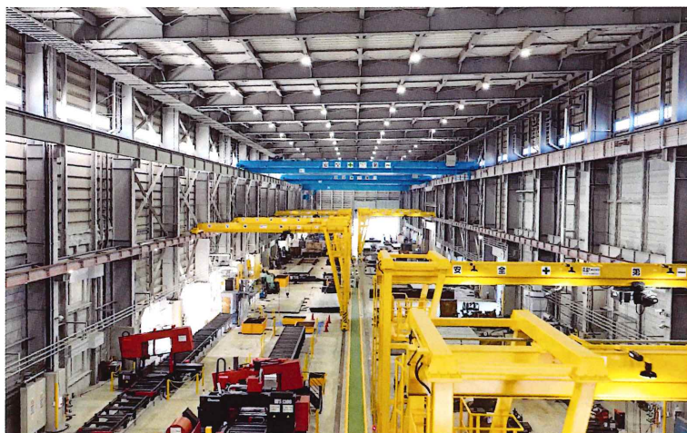
タワー架台 (風車タワーの仮組用架台)
