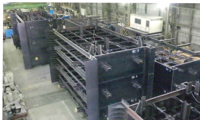
岸壁製作用鋼製枠
