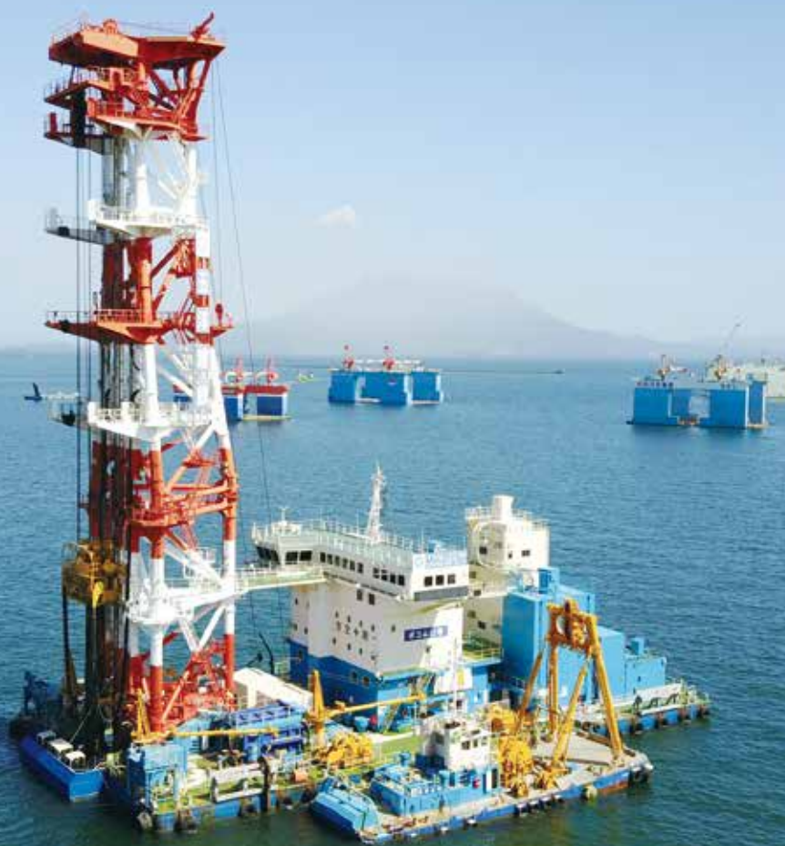
深層混合処理船「ポコム 12 号」 ※地盤改良面積 4.65㎡ (所有者：五洋建設株式会社)
