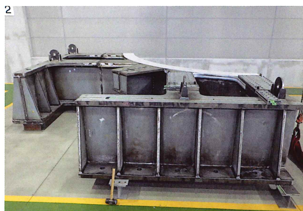
タワー架台 (風車タワーの仮組用架台)
