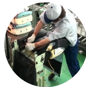
⑦ シートバックの被せ工程
