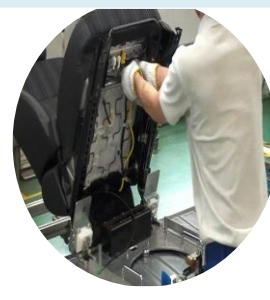
⑧ 配線作業の工程
