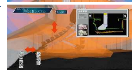
3Dセンサにより船倉の形を計測することができ、船との距離を正確に把握し、衝突を防止します。
