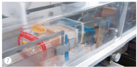
⑦一つひとつのパンが、機械で包装されています。 ⑧しっかり包装されているかを確認。シンプルながら重要な仕事です。
