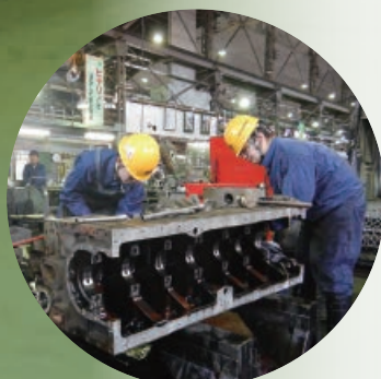
内燃機関検修
