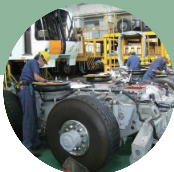
モーター配線取付作業
