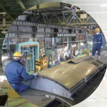
屋根上クーラー検修
