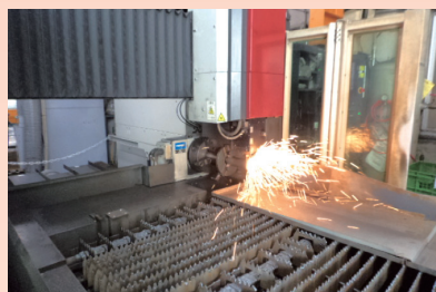
レーザーでのパイプ切断
