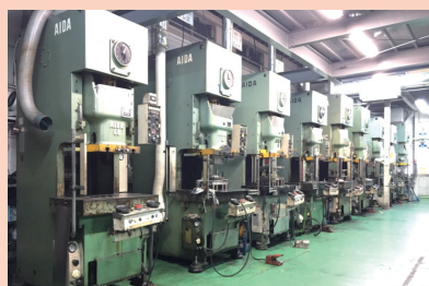
単発型のプレスを複数台並べて連続加工するタンデムプレスライン
