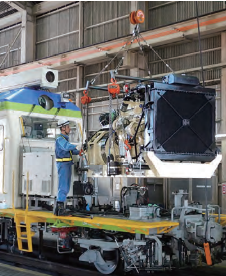
確認車・保全車の保守点検
