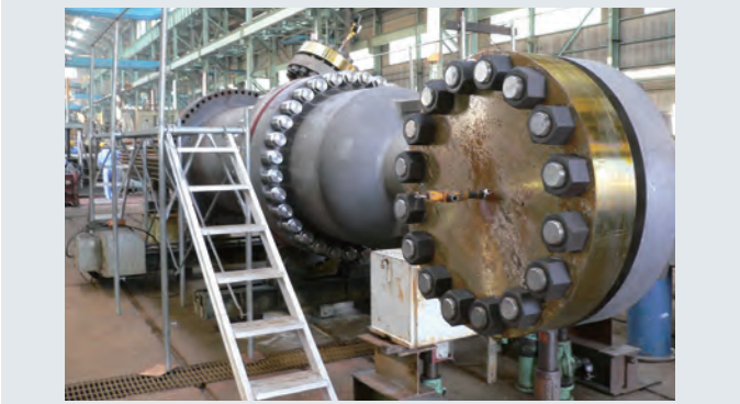
高温高圧熱交換器
