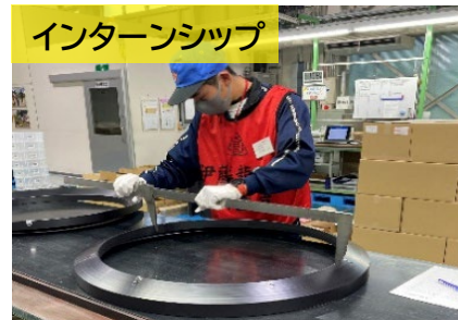
大きなノギスで寸法測定
