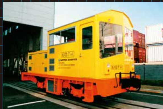
MGTH(マイクロガスタービンハイブリッド)試験車
